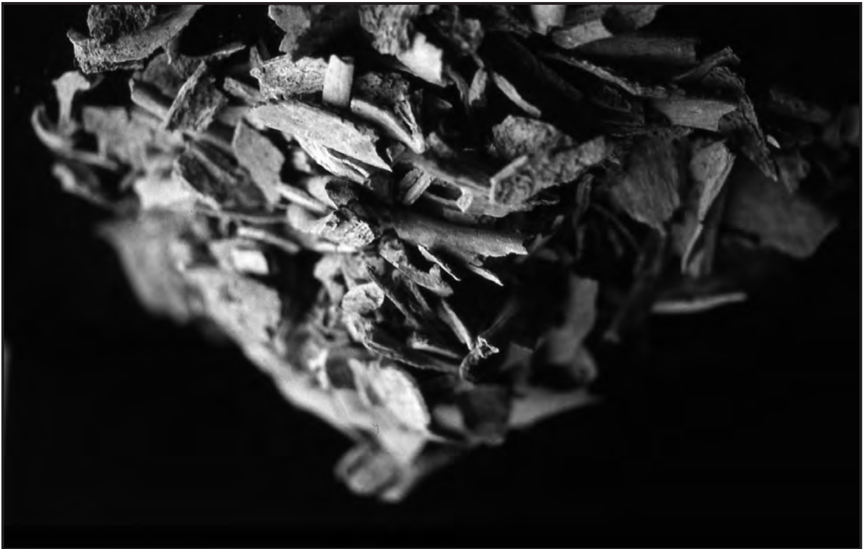
Situation expérimentale, amas déversé d'un contenant dont la morphologie circulaire pourrait faire penser à un effet de paroi (cliché ILG)
