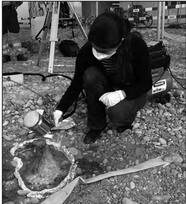
Figure 1 : Vaporisation du cyclododécane au pistolet pulvérisateur ou spray-gun - Crédit photo : ADB
